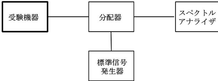
(2) 外部試験装置を用いて試験を行う場合
