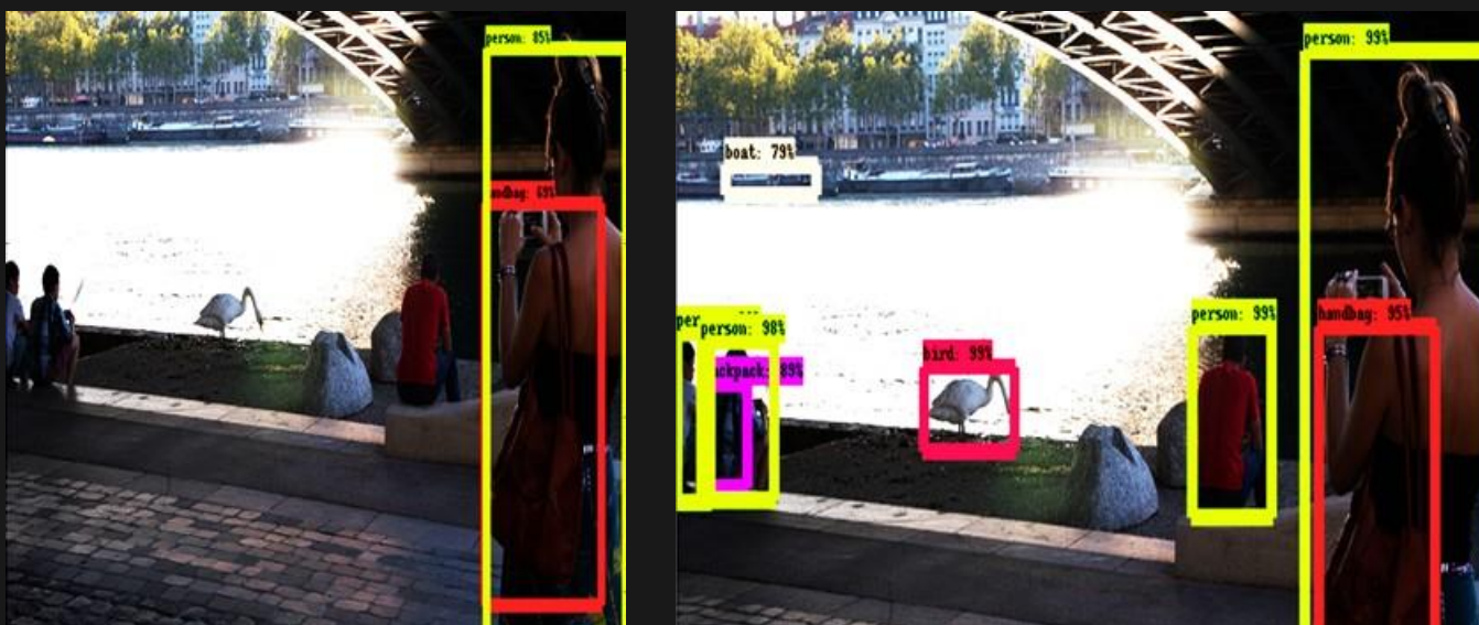
コストと精度のトレードオフの例 エッジ(左)とクラウド(右)では識別精度が異なる
