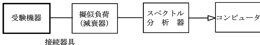
接続器具は、各種導波管変換器等である。
